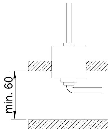
4. Setzen Sie die Leuchte in den Ausschnitt ein und Prüfen Sie die Funktionsweise.
